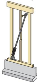
③ブレースとダンパーを連結ナットで繋ぎ、上部の取付ブラケットに仮止めする(同様に連結ナットで長さを調節し、下部取付ブラケットも仮止めする)。
