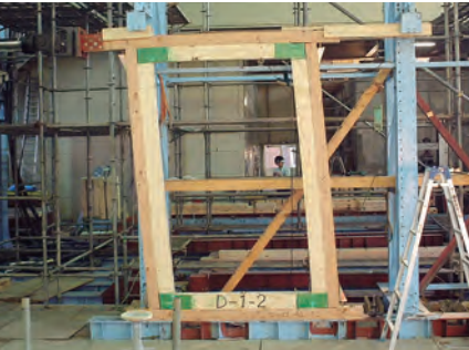
BOX型フレーム試験
