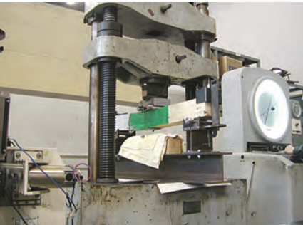
アラミド引張耐力試験(北海道大学 野口研究室)
