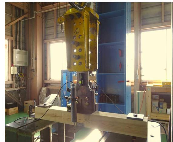
上載梁接合プレート引張試験
