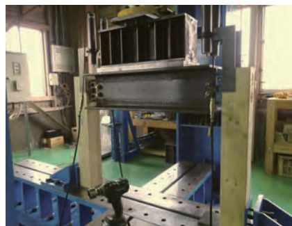
木部-補剛材接合部せん断試験
