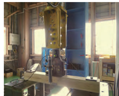
上載梁接合プレート引張試験
