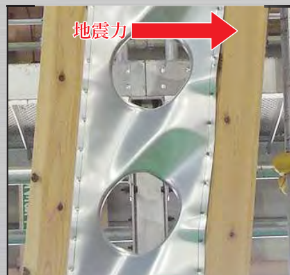
【大地震時】 バーリング面材が変形しエネルギーを吸収 変形しても安定した耐力を発揮
